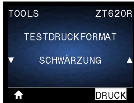
Verwenden Sie diese Option zur Initiierung der Testsequenz, die verschiedene Arten von Etiketten druckt, um Ihnen bei der Fehlerbehebung bei Druckproblemen zu helfen. Beispiele von Etiketten und zusätzliche Informationen finden Sie unter *Option für Drucktestformat auf Seite 232*.
