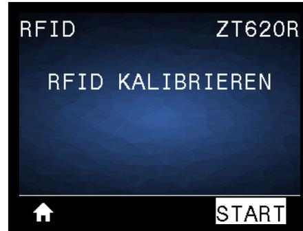
Hiermit können Sie die Tag-Kalibrierung für RFID-Medien starten. (Nicht zu verwechseln mit der Medien- und Farbbandkalibrierung.) Bei diesem Vorgang werden die Medien im Drucker bewegt, die Position des RFID-Tags kalibriert und die optimalen Einstellungen für die verwendeten RFID-Medien bestimmt. Diese Einstellungen beinhalten die Programmierungsposition, das verwendete Antennenelement sowie die verwendete Lese-/Schreibstärke. Weitere Informationen finden Sie im *RFID-Programmierhandbuch 3*.
