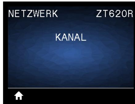
Sie können den Wireless-Kanal anzeigen, der verwendet wird, wenn das Wireless-Netzwerk aktiv und authentifiziert ist.
