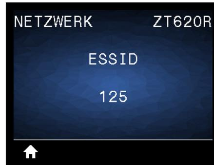
Die Extended Service Set Identification (ESSID) ist eine Kennung für Ihr drahtloses Netzwerk. Diese Einstellung, die nicht vom Bedienfeld aus geändert werden kann, gibt die ESSID für die aktuelle Drahtloskonfiguration an.
