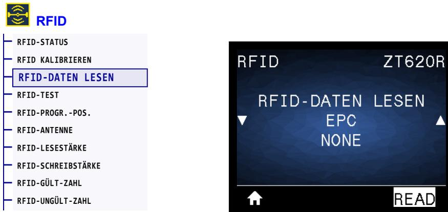
Die Daten des angegebenen Tags werden über die RFID-Antenne vom entsprechenden RFID-Tag gelesen und zurückgegeben. Beim Lesen der Tag-Daten befindet sich der Drucker im Leerlauf. Der Druckkopf kann geöffnet oder geschlossen sein.
