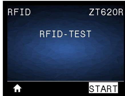
Beim RFID-Test versucht der Drucker, Daten auf einem Transponder auszulesen oder zu schreiben. Während des Tests befindet sich der Drucker im Leerlauf.
