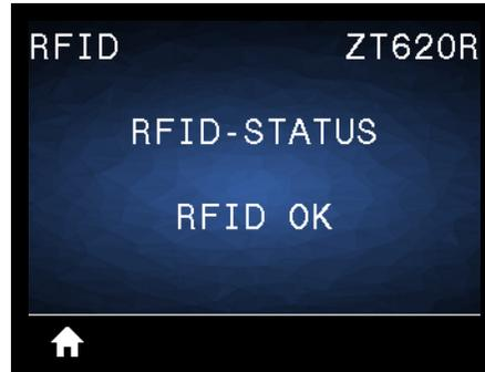
Sie können den Status des RFID-Subsystems des Druckers anzeigen.
