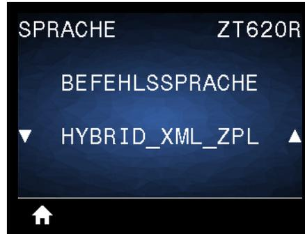
Lassen Sie die entsprechende Befehlssprache anzeigen oder wählen Sie sie aus.
