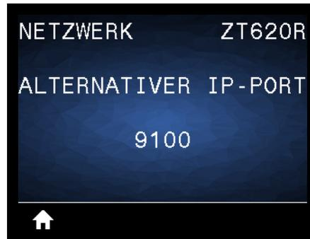
Mit diesem Befehl wird der alternative TCP-Anschluss als Anschlussnummer festgelegt.
