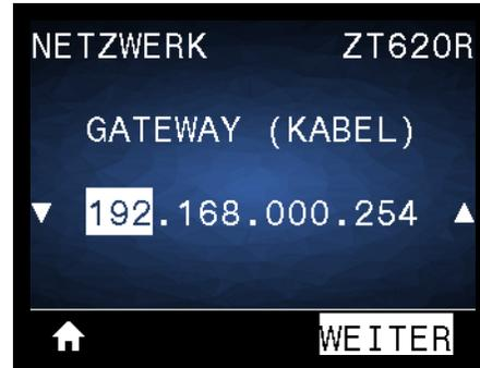
Sie können das drahtgebundene Standard-Gateway anzeigen und bei Bedarf ändern.
