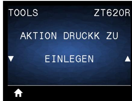
Legen Sie fest, welcher Druckervorgang beim Schließen des Druckkopfes ausgeführt werden soll.
