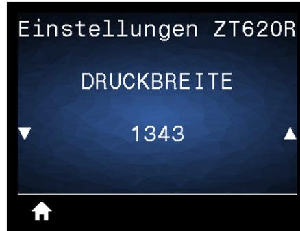
Legen Sie die Breite der verwendeten Etiketten in Punkten fest. Als Standardwert ist die maximale Breite des Druckers auf der Grundlage des dpi-Werts für den Druckkopf festgelegt.
