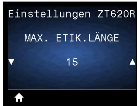
Legen Sie als maximale Etikettenlänge stets einen Wert fest, der mindestens 25,4 mm (1 Zoll) größer als die tatsächliche Etikettenlänge plus Etikettenzwischenraum ist. Wenn Sie diesen Wert zu klein definieren, geht der Drucker davon aus, dass endlose Medien geladen wurden, und kann keine Kalibrierung vornehmen.
