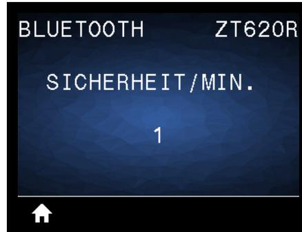
Zeigt die minimale Bluetooth-Sicherheitsstufe des Druckers an.
