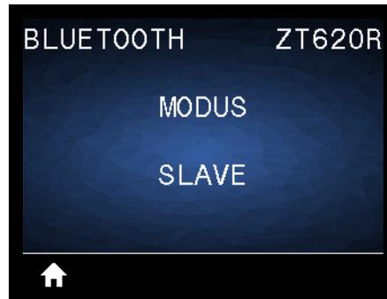
Zeigt den Gerätetyp des Druckers für das Bluetooth-Verbindungspaar an: Slave (üblich) oder Master.
