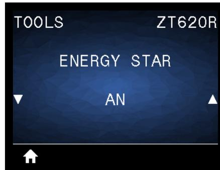
Wenn der Energy Star-Modus aktiviert wurde, geht der Drucker nach einer bestimmten Zeit in den Ruhezustand, wodurch der Stromverbrauch reduziert wird. Drucken Sie eine beliebige Taste auf dem Bedienfeld, um den Drucker wieder zu aktivieren.
