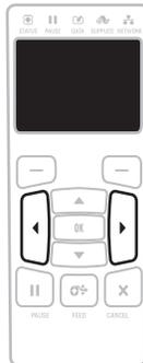
Drücken Sie den PFEIL NACH LINKS oder den PFEIL NACH RECHTS, um einen Bildlauf durch die Elemente in einem Benutzermenü durchzuführen.
