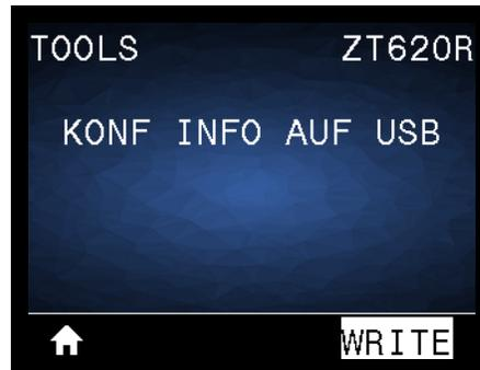
Verwenden Sie diese Funktion, um die Konfigurationsinformationen des Druckers auf ein USB-Speichergerät (z. B. USB-Flash-Laufwerk, das an einem USB-Hostanschluss des Druckers eingesteckt wurde) zu kopieren. Damit kann auf die Informationen zugegriffen werden, ohne dass physische Etiketten gedruckt werden müssen. Angaben zum Drucken der Informationen auf Etiketten finden Sie unter *DRUCKINFORM.* [auf Seite 119](#).
