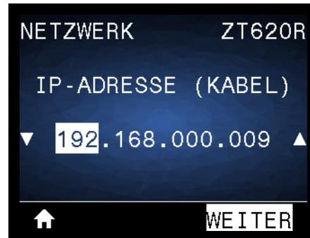
Sie können die drahtgebundene IP-Adresse des Druckers anzeigen und bei Bedarf ändern.
