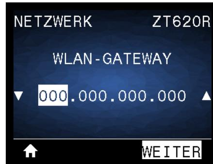
Sie können das kabellose Standard-Gateway anzeigen und bei Bedarf ändern.
