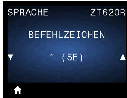
Das Format-Befehlspräfix ist ein zweistelliger Hexadezimalwert, der in ZPL/ZPLII-Formatanweisungen als Markierung für die Parameterposition verwendet wird. Der Drucker sucht nach diesem zweistelligen Hexadezimalzeichen, um den Beginn einer ZPL/ZPLII-Formatanweisung zu kennzeichnen.
