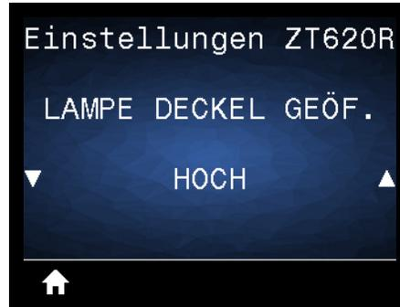
Legen Sie die Helligkeit der Anzeige fest, die bei geöffneter Medienklappe aufleuchtet.
