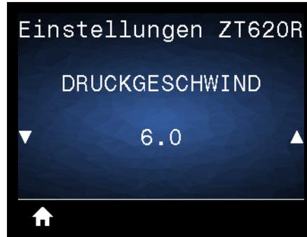
Wählen Sie die Geschwindigkeit für den Ausdruck von Etiketten in Zoll pro Sekunde (Zoll/s). Bei geringerer Druckgeschwindigkeit wird in der Regel eine bessere Druckqualität erzielt.
