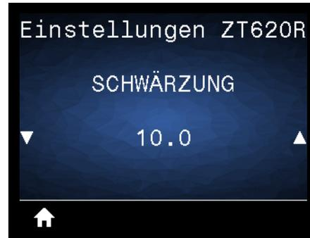
Legen Sie für die Schwärzung die niedrigste Einstellung fest, mit der ein gutes Druckergebnis erzielt werden kann. Wenn der Schwärzungsgrad zu hoch gesetzt ist, wird das Druckbild des Etiketts möglicherweise unscharf, die Strichcodes können unter Umständen nicht richtig eingelesen werden, das Farbband kann durchschmoren oder der Druckkopf vorzeitig verschleifen.
