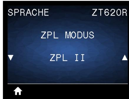
Legen Sie den Modus so fest, dass eine Übereinstimmung mit den verwendeten Etikettenformaten vorliegt. Der Drucker erkennt Etikettenformate, die in ZPL bzw. ZPLII geschrieben sind, sodass vorhandene ZPL-Formate nicht neu geschrieben werden müssen. Der Drucker verbleibt im gewählten Modus, bis er durch eine der hier aufgelisteten Möglichkeiten geändert wird.
