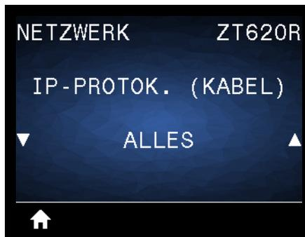
Über diesen Parameter wird angegeben, ob die IP-Adresse des drahtgebundenen Printers vom Benutzer (permanent) oder über den Server (dynamisch) ausgewählt wird. Wenn eine dynamische Option ausgewählt ist, wird mit diesem Parameter die Methode angegeben, mithilfe derer dieser Printserver die IP-Adresse vom Server abrufen. Weitere Informationen finden Sie unter *Änderung der IP-Adresse* auf Seite 262.
