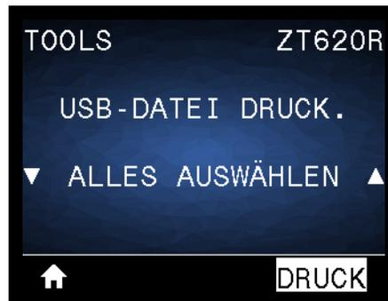
Der Drucker lädt alle ausführbaren Dateien und verarbeitet sie. Die verfügbaren Dateien werden aufgelistet. Über **ALLES AUSWÄHLEN** können Sie alle Dateien vom USB-Flash-Laufwerk ausdrucken.
