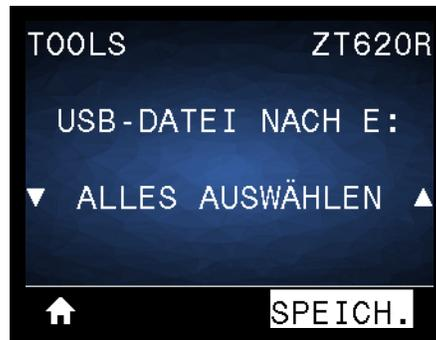
Der Drucker lädt alle ausführbaren Dateien und verarbeitet sie. Die verfügbaren Dateien werden aufgelistet. Über **ALLES AUSWÄHLEN** können Sie alle verfügbaren Dateien vom USB-Flash-Laufwerk kopieren.
