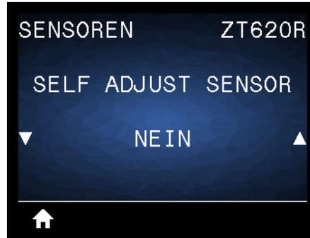
Aktivieren Sie diese Einstellung, damit der Drucker versucht, die Medieneinstellungen automatisch zu erkennen. Sie müssen den Drucker ggf. doch manuell kalibrieren, wenn Ihr Medium über diese Einstellung nicht ordnungsgemäß erkannt wird.
