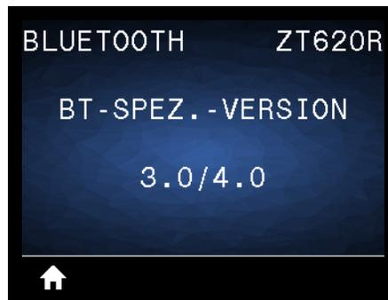
Zeigt die Bluetooth-Spezifikation für den Betrieb des Druckers an.
