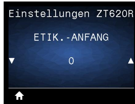
Bei Bedarf können Sie die Position des Bildes auf dem Etikett vertikal anpassen.
