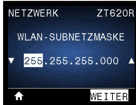
Sie können die kabellose Subnetzmaske anzeigen und bei Bedarf ändern.
