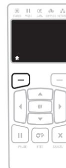
Drücken Sie die LINKE AUSWAHLTASTE, um das Startmenü zu verlassen und zur Leerlaufanzeige zurückzukehren. Der Drucker kehrt nach 15 Sekunden Inaktivität im Startmenü automatisch zur Leerlaufanzeige zurück.
