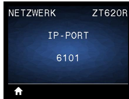
Diese Druckereinstellung bezieht sich auf die Anschlussnummer des intern verdrahteten Printservers, den der TCP-Druckdienst überwacht. Normale TCP-Verbindungen vom Host sollten zu diesem Anschluss geleitet werden.
