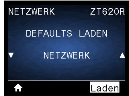
Mit dieser Option setzen Sie alle Einstellungen für Drucker, Printserver und Netzwerk auf die werkseitig festgelegten Standardeinstellungen zurück. Verfahren Sie sorgfältig beim Laden der Standardeinstellungen, da Sie alle manuell geänderten Einstellungen neu laden müssen. Dieses Menüelement ist in zwei Benutzermenüs mit jeweils unterschiedlichen Standardwerten verfügbar.
