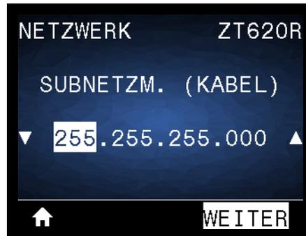
Sie können die drahtgebundene Subnetzmaske anzeigen und bei Bedarf ändern.
