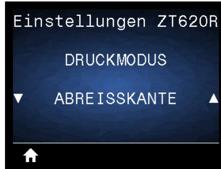
Wählen Sie einen Druckmodus aus, der mit den Optionen Ihres Druckers kompatibel ist. Informationen zur Auswahl des Druckmodus und den verschiedenen Druckeroptionen finden Sie unter *Auswählen des Druckmodus* auf Seite 31.
