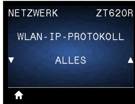
Über diesen Parameter wird angegeben, ob die IP-Adresse des kabellosen Printers vom Benutzer (permanent) oder über den Server (dynamisch) ausgewählt wird. Wenn eine dynamische Option ausgewählt ist, wird mit diesem Parameter die Methode angegeben, mithilfe derer dieser Printer die IP-Adresse vom Server abrufen. Weitere Informationen finden Sie unter *Änderung der IP-Adresse* auf Seite 262.
