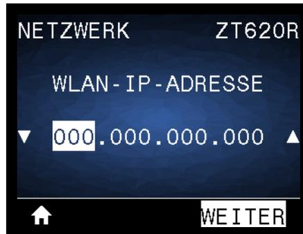
Sie können die kabellose IP-Adresse des Druckers anzeigen und bei Bedarf ändern.
