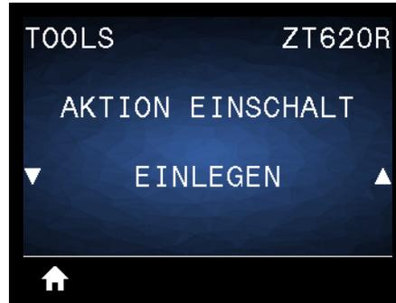
Legen Sie fest, welcher Vorgang während des Einschaltens des Druckers ausgeführt werden soll.
