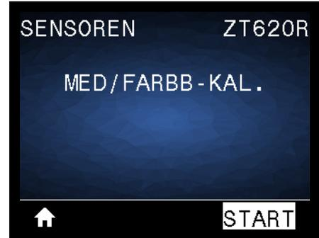
Kalibrieren Sie den Drucker zur Anpassung der Empfindlichkeit der Medien- und Farbbandsensoren.
