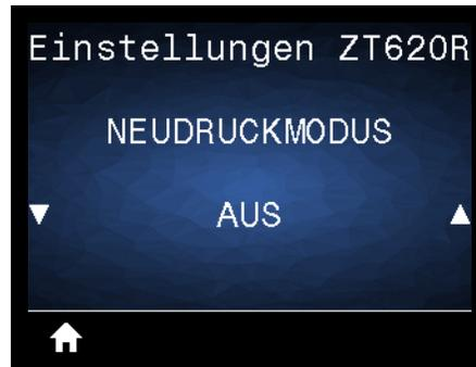
Wenn der Neudruckmodus aktiviert ist, können Sie das zuletzt gedruckte Etikett erneut drucken, indem Sie PAUSE UND ABBRECHEN oder die PFEIL-NACH-UNTEN-TASTE in der Leerlaufanzeige des Druckers gedrückt halten.
