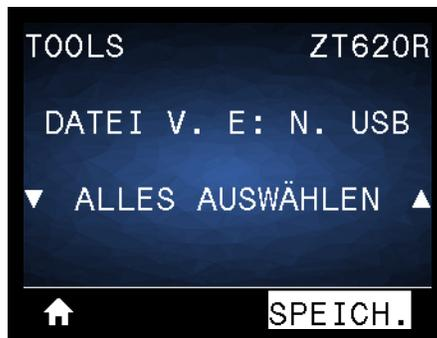
Über **ALLES AUSWÄHLEN** können Sie alle verfügbaren Dateien vom Drucker auf dem USB-Flash-Laufwerk speichern. Kopierte .ZPL-Dateien werden nachbearbeitet, damit der Inhalt der Datei an den Drucker gesendet und dort normal ausgeführt werden kann.
