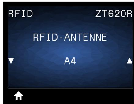
Wenn die gewünschte Antenne durch die Kalibrierung des RFID-Tags nicht ausgewählt werden kann, kann ein Wert angegeben werden.
