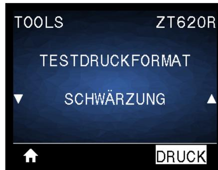
Der Drucker wiederholt den Druck eines Bildes mit steigenden Schwärzungsstufen. Mit **ABBRECHEN** können Sie den Druck jederzeit unterbrechen, wenn das Muster klar und lesbar ist.
