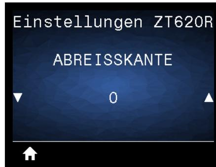
Ändert bei Bedarf die Position der Medien auf der Abrissleiste nach dem Drucken.
