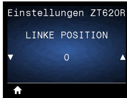
Bei Bedarf können Sie die Position des Bildes auf dem Etikett horizontal anpassen.
