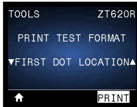
Der Drucker druckt ein Bild, damit Sie die Position des Bildes auf Ihren Etiketten bei Bedarf einstellen können. Die Linien auf dem gedruckten Bild vom oberen Etikettenrand und der linken Ecke geben die Position der oberen linken Ecke des Etiketts an.
