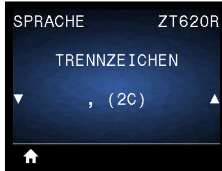
Das Trennzeichen ist ein zweistelliger Hexadezimalwert, der in ZPL/ZPLII-Formatanweisungen als Markierung für die Parameterposition verwendet wird. Legen Sie das Trennzeichen so fest, dass eine Übereinstimmung mit den verwendeten Etikettenformaten vorliegt.
