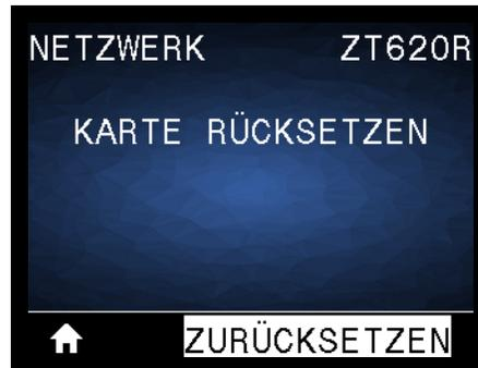
Mit dieser Option wird der drahtgebundene oder drahtlose Printserver zurückgesetzt. Änderungen an den Netzwerkeinstellungen werden gespeichert.
