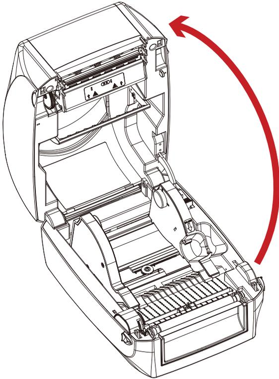
Der Druckmechanismus wird mit dem Gehäusedeckel angehoben
