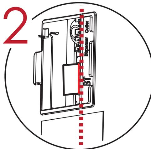
Schieben Sie die Karte ganz hinein. Die Markierung auf der Bluetooth-Karte muss mit der Kante des Mainboards bündig sein, da sonst Übertragungsfehler auftreten können.
