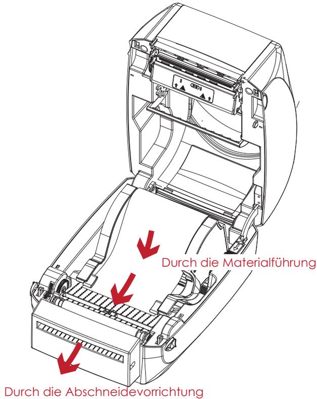
2. Schließen Sie den Druckmechanismus. Drücken Sie abschließend die FEED-Taste, um die Etikettenposition einzustellen.
