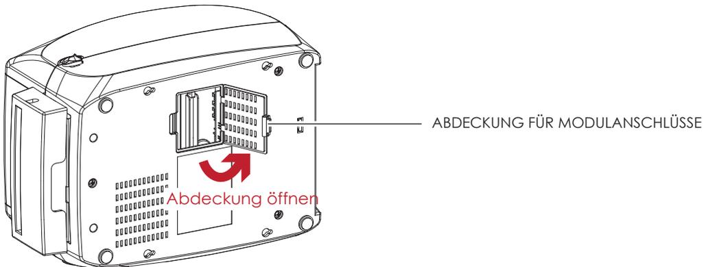
6. Stecken Sie das Verbindungskabel für die Abschneidevorrichtung in den dafür am Drucker vorgesehenen Anschluss.
