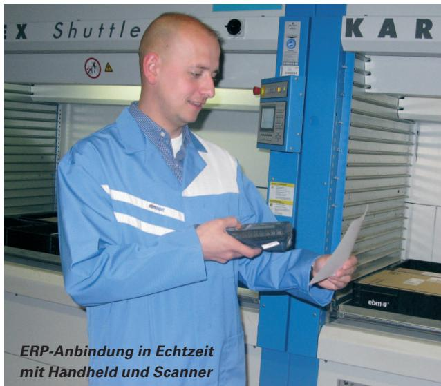
mit Scannerunterstützung: Die einzelnen Stellplätze sind mit Barcodes gekennzeichnet, so dass die Zuordnung Ware – Lagerplatz fehlerfrei registriert wird. Im Produktionsversorgungsbereich (PVB) unterstützen Scanner den Materialfluss: Pool-Kanban-Artikel werden mittels Scanner eingebucht. Die fertigen Produkte werden direkt am Arbeitsplatz zurückgemeldet und wieder in das ERP-System eingebucht. Die Anbindung über ein WLAN garantiert maximale Bewegungsfreiheit.
