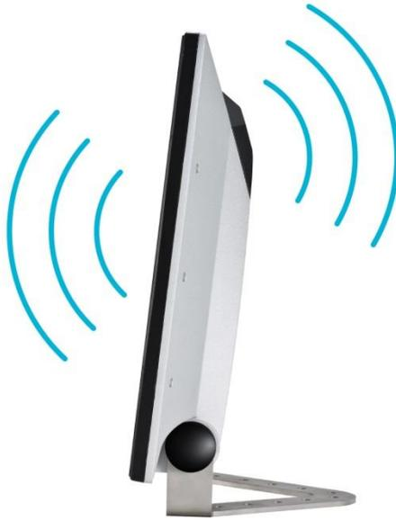
WLAN Antennenabstrahlung vorne und hinten
