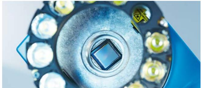
High-Speed-Kamera mit zwei oder vier Megapixelkamera und dynamischem Fokus für höchst flexible Leseleistung
